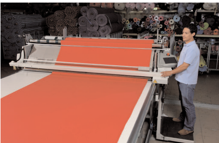
GERBERSpreader™ Máquina de enfiesto para estendimentos sem tensionar a malha/tecido.
