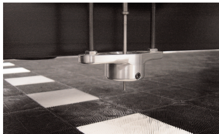
Furador de tecido - até 12,7 mm de diâmetro
