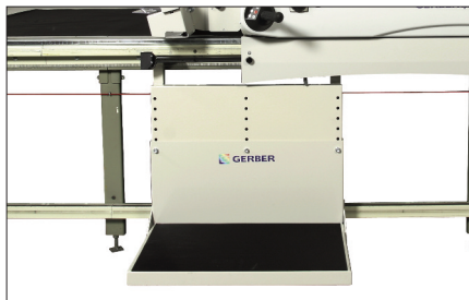
Plataforma do operador.
