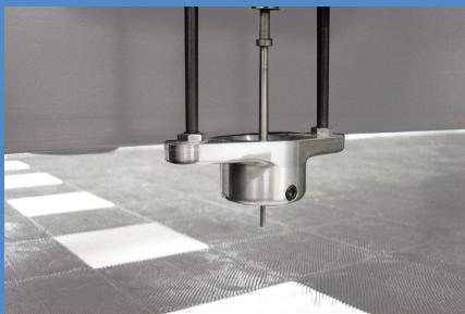
Cabeça de furação motorizada equipada com o sistema "Quick Change Drill", para rápida mudança do furador sem necessidade de ferramentas.
